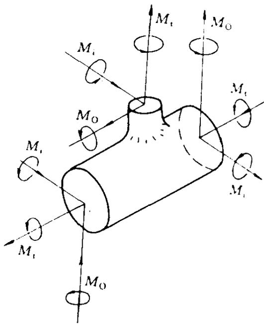
图 9.4.2-3 平面内、平面外应力
