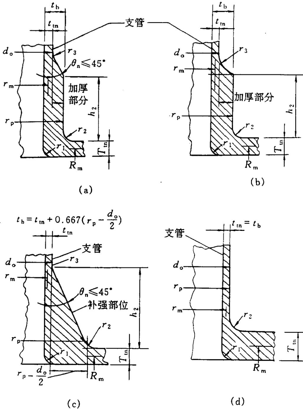
图 E.0.4 支管接头尺寸(mm)
