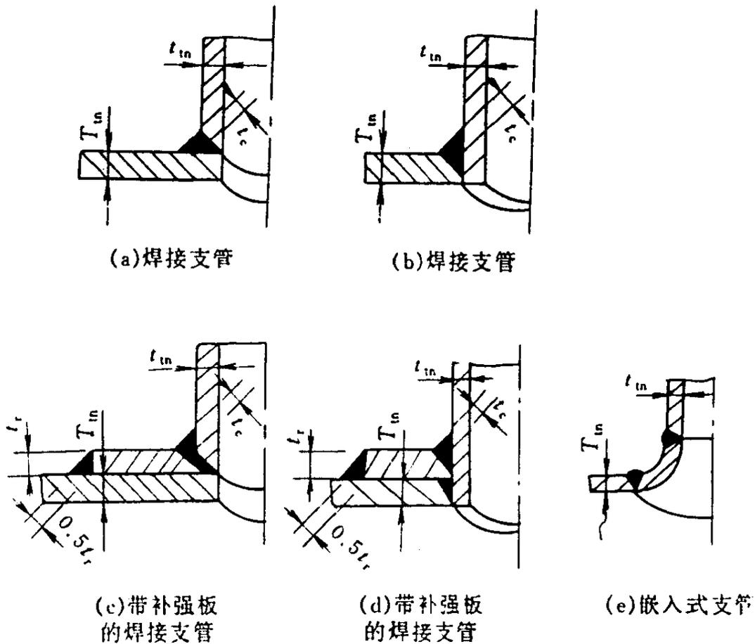
图 5.4.4-1 支管连接焊缝的形式
