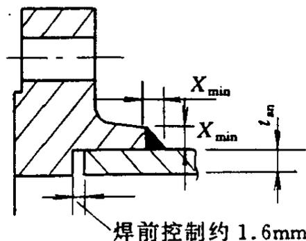
图 H.1.3 承插焊法兰的连接要求
