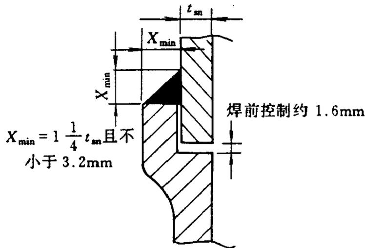
图 H.1.2 承插焊管件连接要求
