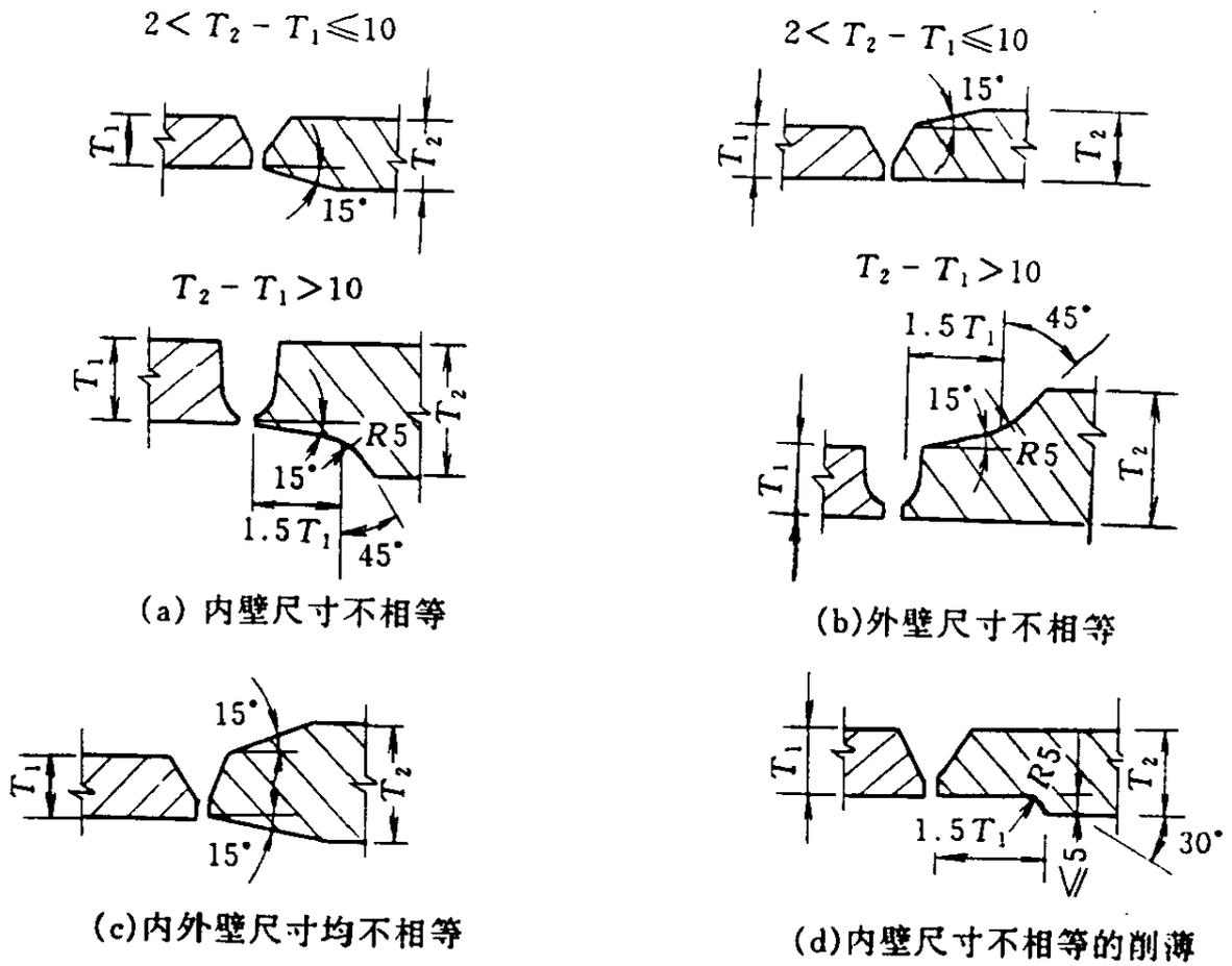
图 H. 2. 2 不同厚度管道组成件的对焊端部型式
