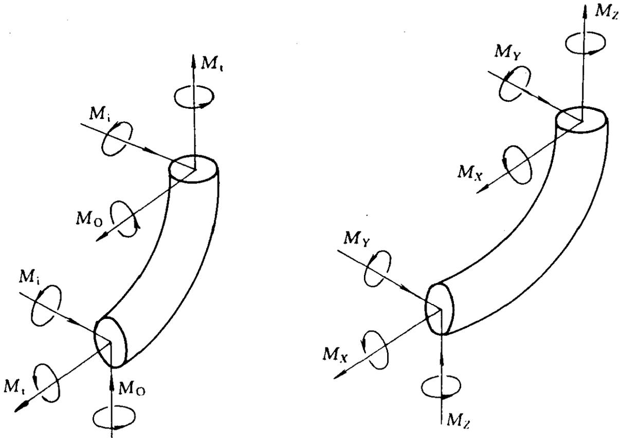
图 9.4.2-1 平面内、平面外应力
