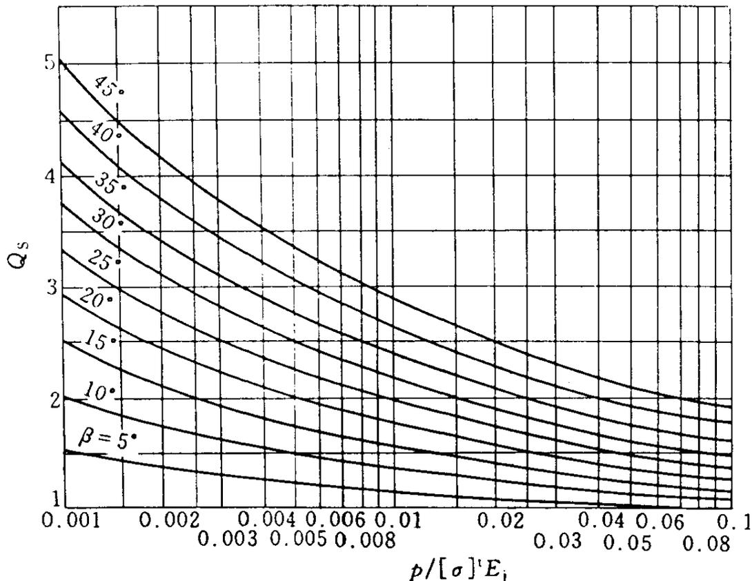
图 6.5.2-2 异径管小端与圆筒连接处的  $Q_s$  值图
